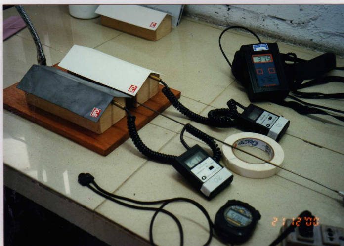
Foto nº. 04 Verificação das temperaturas durante resfriamento.
