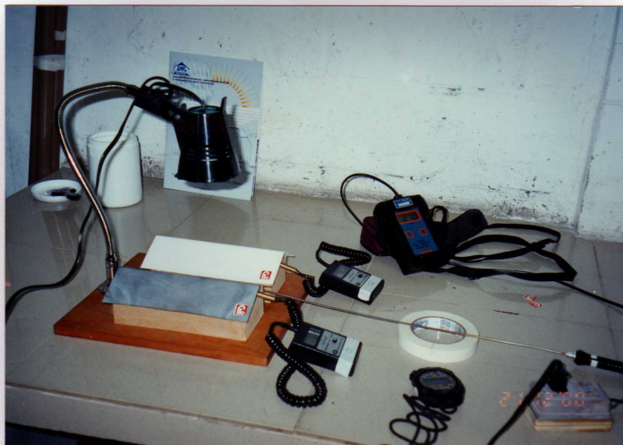
Foto nº. 03 Verificação das temperaturas durante aquecimento.
